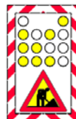
Semnalizarea unui utilaj care se deplasează lucrând
