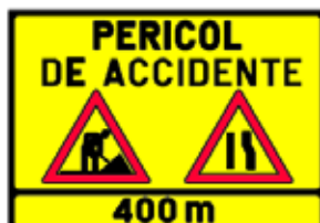
Presemnalizarea unui sector cu circulație alternantă
