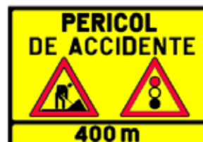
Presemnalizarea unui sector cu circulație alternantă
